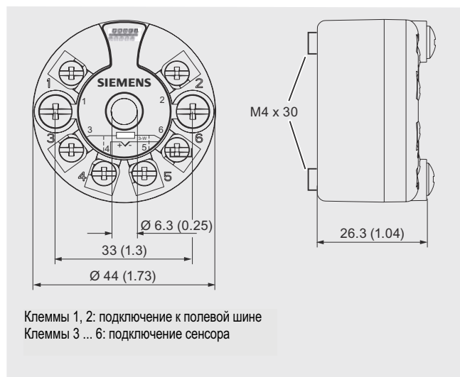
SITRANS TH400, размеры в мм (дюймах) и соединения
